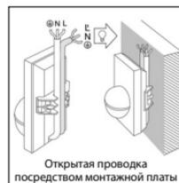
**Указание:** Для монтажа к стене можно использовать имеющийся в комплекте монтажный угольник. Благодаря этому проводка может проложиться, провода их за стенкой сенсора в отверстия, предусмотренные для открытой проводки.
